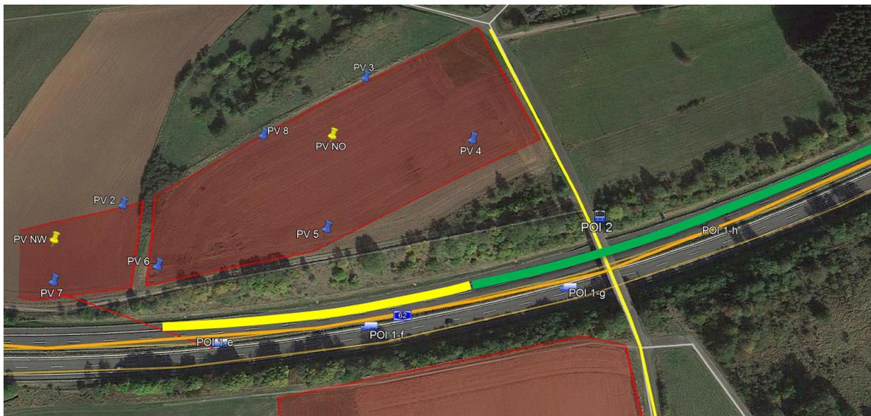
**Abbildung 17: In Fahrtrichtung West relevante Abschnitte gelb: z.T. lückenhafte Vegetation, grün: überwiegend dichte Abschirmung**
