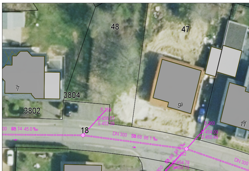
Kanalplan (Mischwasserkanal); Quelle Gemeinde Nonnweiler
